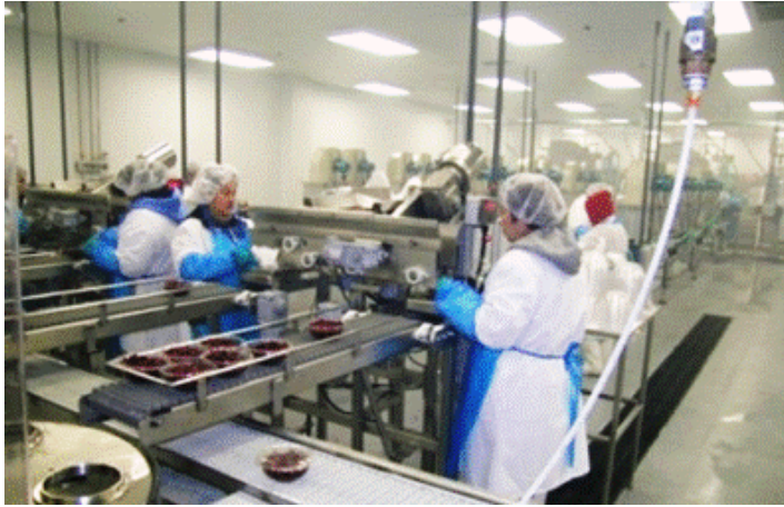
تصویر ۸-۱۱- کارگاه مکانیزه‌ی تهیه‌ی اناردان تازه
