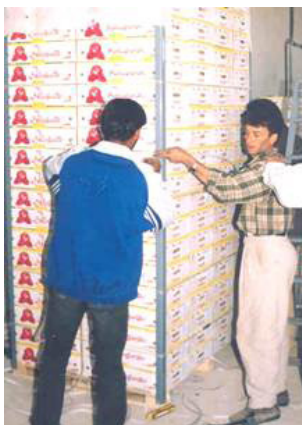
تصویر ۸-۷- قراردادن نبشی در چهار گوشه‌ی کارتن‌های میوه‌ی انار قرارگرفته روی پالت و تسمه‌کشی
